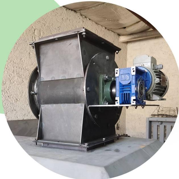
روتاری ولو (ایرلاک) تجهیزی است که به مواد اجازه عبور از یک تجهیز به تجهیز دیگر با فشار هوا و متفاوت را می دهد و مانع از انتقال فشار بین آن دو می گردد. روتاری ولو در خروجی دستگاه یا پایین مخزن نصب می شود و وظیفه باربری و کنترل میزان بار خروجی نسبت به بار ورودی را برعهده دارد.
