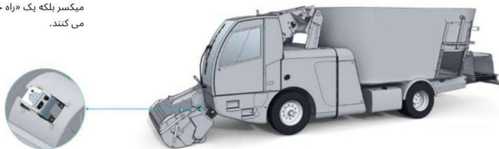
EvoNIR در زمان واقعی ماده خشک و مواد مغذی کلیدی (پروتئین، ADF، NDF، حاکستر، چربی خام، نشاسته و غیره) را اندازه گیری می‌کند. این سیستم در زمان واقعی وزن بارگیری شده را مجددآ محاسبه می‌کند تا از یک جیره ثابت اطمینان حاصل کند. تمام داده‌ها در نرم افزار تغذیه ابری DTM ذخیره می‌شوند.
