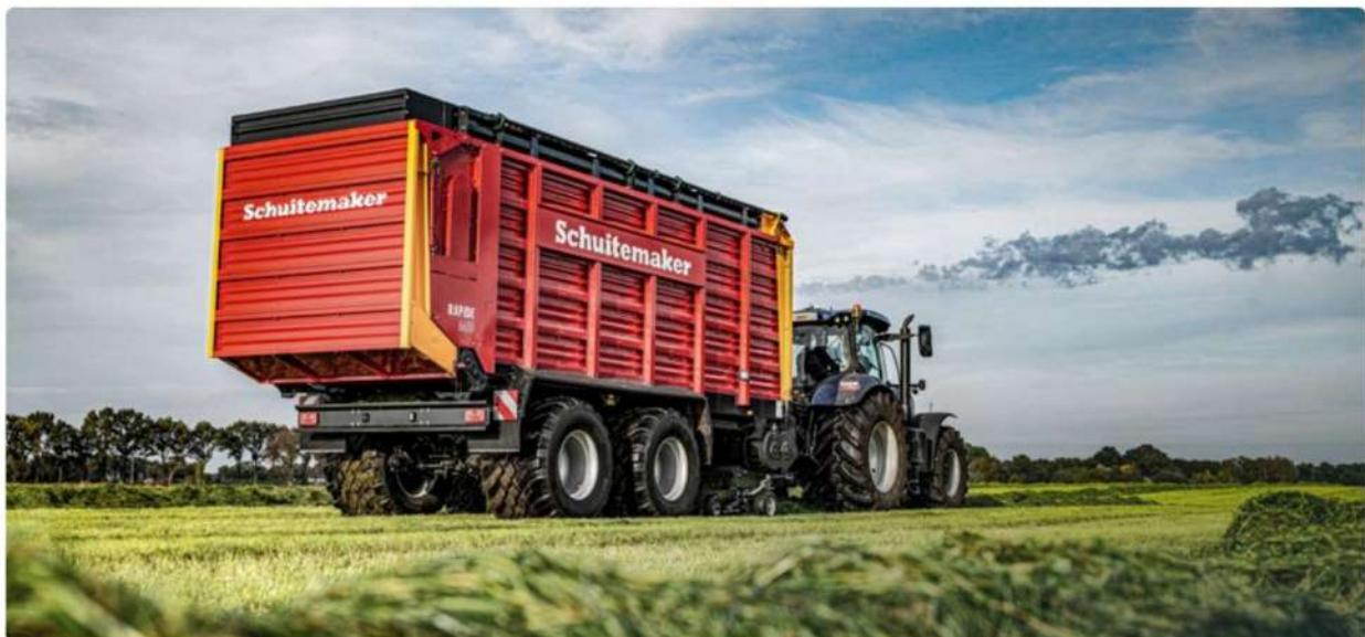
سیستم مجهز به حسگر NIR مقدار دقیق هر بار و هر لات را اندازهگیری می کند و داده های جمع آوری شده در محل را می توان در میدان با ترمینال در کابین تراکتور خواند.
